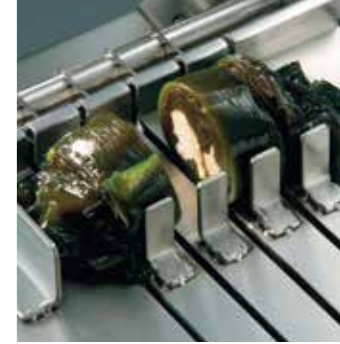
●すべり止加工 写真は実際に昆布巻工場に納品された特注品です。
