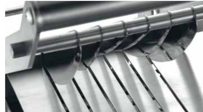
●段違い刃 安全のため研がない刃をつけた場合に食材に当たるタイミングを時間差にして抵抗感を抑える。
